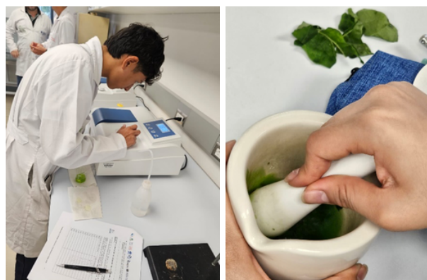
Utilización de espectrofotómetro y extracción de clorofila. Fotografías por: Kenneth Castillo Rodríguez, 2025
